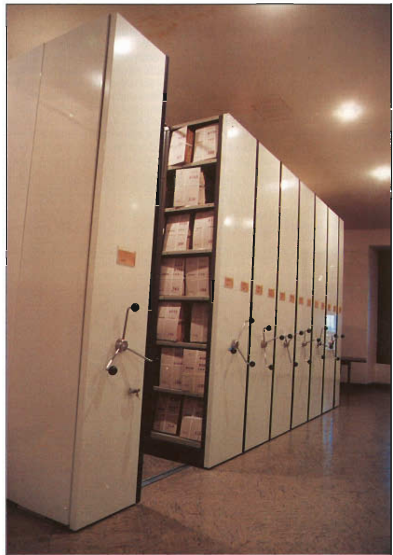
Armarios-estanterías con deslizamiento lateral tipo compacto donde se almacenan los legajos.
