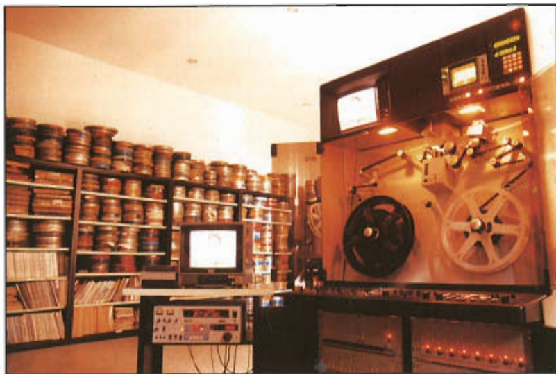
En esta sala es donde mediante el telecine digital que aparece a la derecha de la imagen, se transforman las películas cinematográficas a video.
